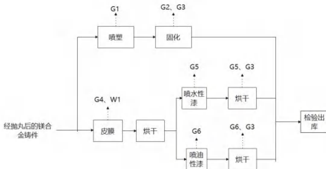
图 3.5-1 本项目生产工艺流程及产污环节
